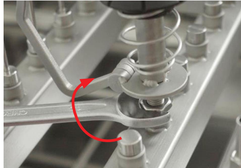
Figura 2: Apriete la rosca del adaptador en las pinzas de la unidad del inyector móvil.
