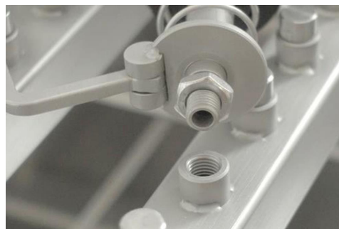
Figura 1: Apriete la rosca del adaptador en las pinzas de la unidad del inyector móvil.
